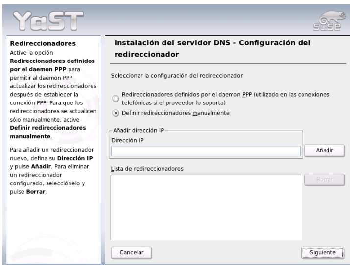
Figura 22.5: Instalación del servidor DNS: redireccionadores
