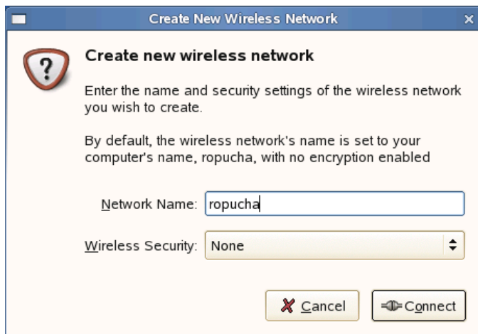
11-2. ábra Hozzáférési pont beállítása
