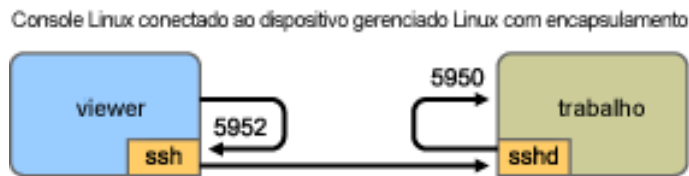
Figura I-1 Console Linux conectado ao dispositivo gerenciado Linux com encapsulamento
